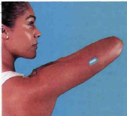
**Il sensore indossabile de L'Oréal che, attraverso una rete di microcanali, misura i livelli di pH della pelle.**
